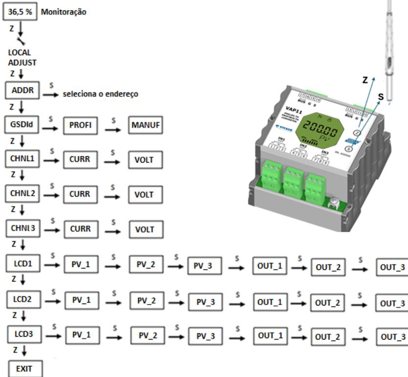
Para sua configuração, o conversor possui ajuste local via chave magnética, de uso intuitivo, com função de rápida edição.
